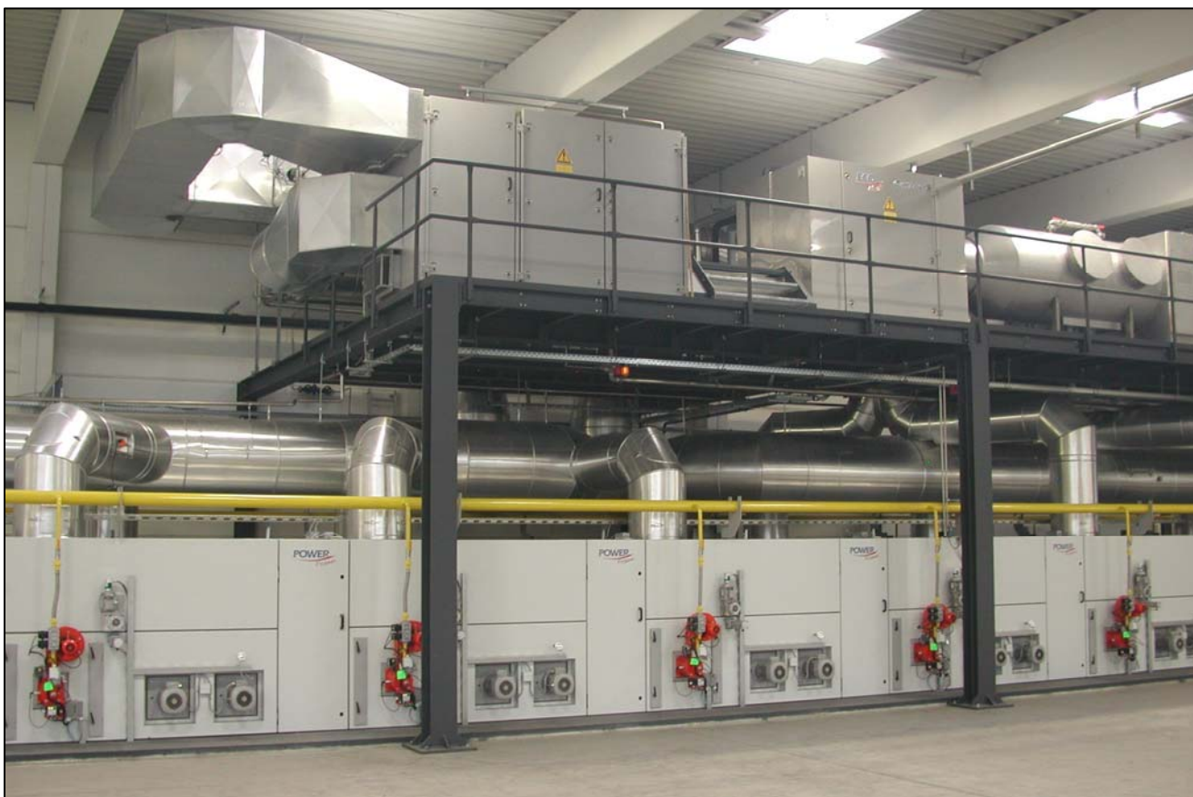
Grafik 4: BRÜCKNER Wärmerückgewinnungs- und Abluftreinigungssystem ECO-HEAT und ECO-AIR auf einer Vliesstoffausrüstungsanlage
